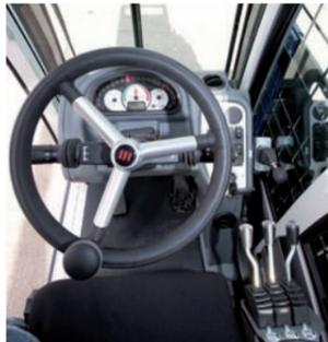
Der Seitenstapler wird mit einer hydraulisch vorgesteuerter Mehrhebel- oder Joystick-Bedienung angeboten. Aufgrund der staubigen und harten Einsatzbedingungen wird vom Einbau elektrischer Joysticks abgeraten. Die
