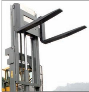
Der Mast auf den neuen GS 150-180 verfügt über größer dimensionierte Profile und Hubmastrollen, um den erhöhten Belastungen stand zu halten.
