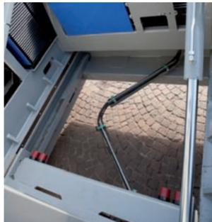
Die horizontale Schlauchführung zum Mast ist unten angebracht, um dem Fahrer einen sicheren Übergang hinter dem Mast zu garantieren.
