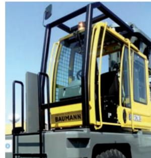
Kabinenschutz zur optimalen Sicherheit des Fahrers.
