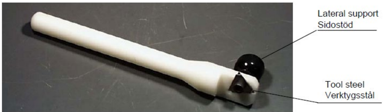
Fig. 2 Top side view of scribing tool / Ritsdonet sett snett uppifrån
