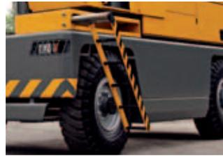
Ab einer gewissen Plattformhöhe erleichtert die elektrische Treppe den Ein- und Ausstieg in die Kabine erheblich. Sekundenschnell fährt die Treppe auf Knopfdruck ein oder aus. Der sicherste Weg von und in die Kabine.
