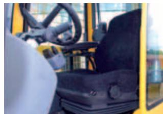
Um ein Höchstmaß an Komfort und Bedienerfreundlichkeit sicherzustellen, ist in den Baumann Kabinen auch ein schwenkbarer Sitz auf Wunsch erhältlich. Dieser eröffnet dem Fahrer einen weitaus größeren Blickwinkel zur Last und nach hinten.
