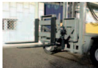
Exakt auf die Lasten abgestimmte Anbaugeräte werden von BAUMANN Großteils selbst gefertigt. Integriert in den Gabelträger werden diese ohne Tragkraft- bzw. Nutzbreitenverlust angeboten. Ob bei wechselnden Lasten oder sich durchbiegendem Langgut, BAUMANN bietet eine Vielzahl an Lösungen und kombiniert diese für den universellen Einsatz des Seitenstaplers.
